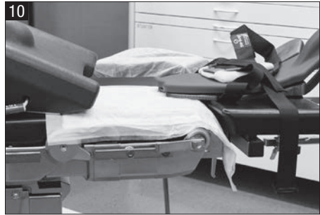
10 Entweder zwischen Antritts-Sitzkissen und BC-Schiene den OP-Tisch mit einer kleinen Unterlage abdecken,
